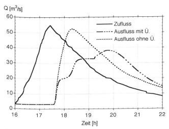
Bild 3. Die beobachtete Zuflussganglinie und die simulierten Ausflussganglinien der Fliessstrecke Huttwil-Lotzwil für das Hochwasser 1978. Mit Überflutungen wird der Hochwasserscheitel von 55 auf 38 m³/s reduziert, ohne Überflutungen ist die Scheitelabminderung vernachlässigbar.
