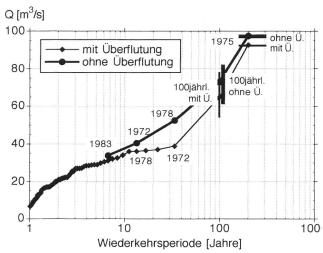
Bild 4. Frequenzdiagramm für den Pegel Langete/Lotzwil für den Zustand mit und ohne Überflutungen der Vorländer. Die Scheitelabflüsse der Hochwasser ohne Überflutungen und des 100jährlichen Ereignisses wurden durch Simulation des Hochwasserwellenablaufes ermittelt. Die 15- bis 50jährlichen Ereignisse werden am stärksten durch die Vorlandüberflutungen abgemindert.
