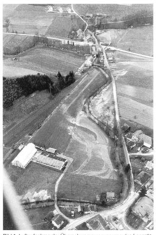
Bild 1. Luftaufnahme der Überschwemmungsspuren des Langetehochwassers vom 22. November 1972 mit einem Scheitelabfluss von 24 m³/s in Huttwil und 38 m³/s in Lotzwil (Foto Binggeli). Die Langete fliesst von Kleindietwil (unten) in Richtung Westen nach Weinstegen.
