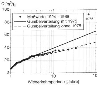
Bild 2. Frequenzdiagramm der Jahreshochwasser der Langete in Lotzwil. Durch Anpassung einer Gumbelverteilung an die Beobachtungen wird ein 100jährliches Hochwasser von 66 m³/s ermittelt. Ohne das Hochwasser 1975 ergibt sich ein 100jährlicher Abfluss von 48 m³/s.
