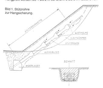
einander von unten aufeinanderfolgend eingebaut und der Rohrgraben möglichst mit Aushubmaterial sofort wieder zugeschüttet und verdichtet. Falls erforderlich wird im durchlochten Rohrbereich wasserdurchlässiges Material eingebaut, um einen Aufstau von Hangwasser zu vermeiden oder die Entspannung von Porenwasser zu ermöglichen.
