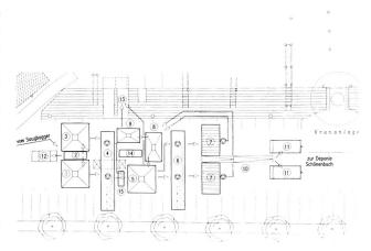
Bild 1. Schema der Schlammentwässerungsanlage.
