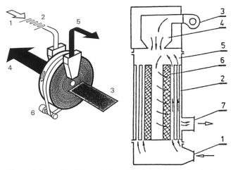
Figure 3, à gauche. Concentrateur de solvants. 1 entrée air, 2 calorifière, 3 gaz à traiter, 4 gaz dépuré, 5 air malodorant concentré, 6 moteur.
