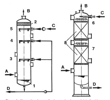
Figure 1. Absorption (appareils de gauche: laveur à jets liquides; appareil de droite: colonne garnie). A gaz à traiter, B gaz épuré, C absorbant, D absorbant saturé de COV. 1 absorbant évacué, 2 séparateur de gouttes, 3, 4, 5 pulvérisation du liquide, 6, 7 zone d'arrosage, 8 lit de garnissage.
