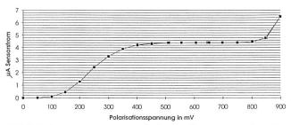
Bild 3. Polarogramm des Oxysafe-Sauersoffsensors in luftgesättigtem Wasser bei 25°C. Soln 1X/2. Im Bereich 400 mV bis 900 mV zusätzlich von oben nach unten gemessen (Messungen vom 8. November 1993. H. Maurer, SWAN AG, 8616 Riedikon).
