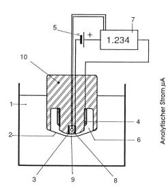
Bild 1. Schematischer Aufbau des Clark-Sensors. Erklärungen der Ziffern siehe Text.
