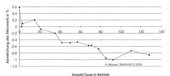
Bild 4. Oxysafe-Sauerstoffsensor, Langzeitstabilität in luftgesättigtem Wasser von 30 °C.
