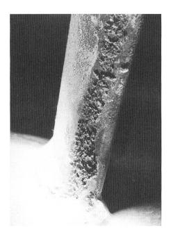
Figure 3. Erosion par cavitation d'une aube.
