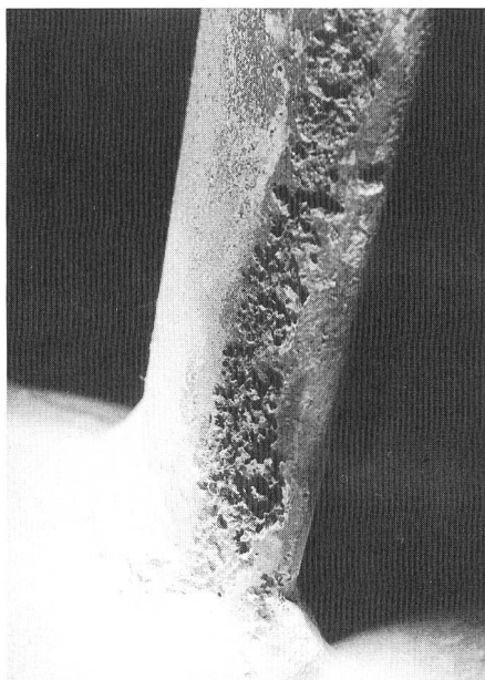
Figure 3. Erosion par cavitation d'une aube.
