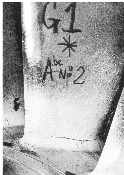
Figure 4. Fissure à l'attache d'une aube côté moyeu.
