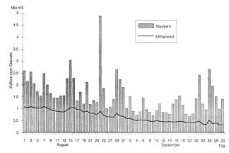
Bild 7. Grösste und durchschnittliche Tageszuflussmengen der Periode 1970 bis 1992.
