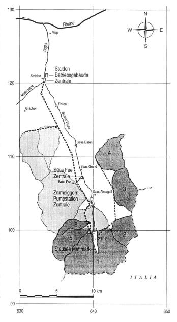
Bild 1. Übersichtsplan der hydraulischen Anlagen im Saastal mit Einzugsgebieten, Staudamm Mattmark, Zentralen Zermeiggern und Stalden.
