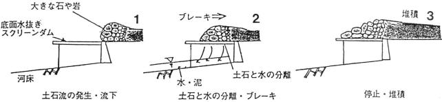
Bild 5: Prinzipskizze einer Murbremse.
