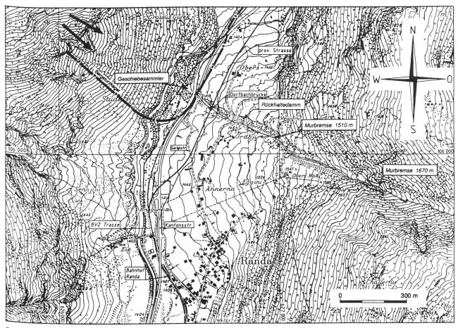
Bild 4: Murgangverbauungen im Dorfbach von Randa, Situation. Die Murbremse auf 1510 m (horizontaler Rost) mit dem Rückhaltedamm kann etwa 12 000 m³, der Geschiebesammler an der Mündung etwa 15 000 m³ zurückhalten. Die Murbremse auf 1680 m (Schlitzdamm) wurde wegen unsicheren Verhaltens im Lastfall nicht ausgeführt.
