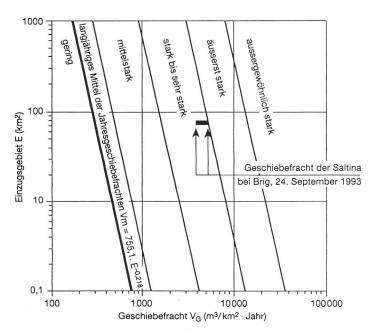
Bild 4. Darstellung der spezifischen Geschiebefrachten in Funktion der Einzugsgebietsgrössen (Zeller 1985). Wir erkennen, dass die Geschiebefracht der Saltina am 24. September 1993 sehr stark bis äusserst stark war. Laut Schätzungen wurden zwischen 300 000 und 400 000 m³ Material transportiert bei einem Einzugsgebiet von 77,7 km². Das Diagramm zeigt für diese Grösse ein langjähriges Mittel von knapp 300 m³/km².
