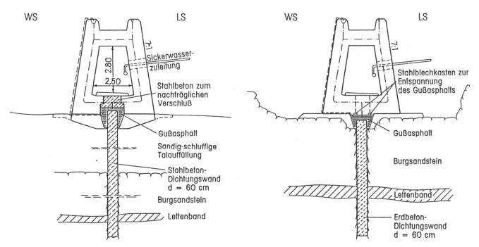
Bild 2. Kontrollgangkonstruktion mit Anschluss zur Schlitzwand unterschiedlicher Steifigkeit – im Bereich der Talsohle (links) und der Hänge (rechts) [3].
