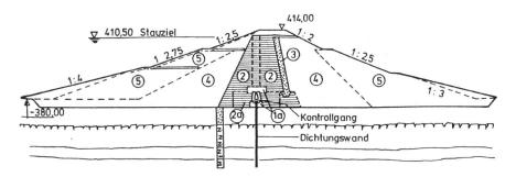
Bild 1. Regelquerschnitt des Brombach-Staudamms: 1a, 2 und 2a innere und äussere Kernzonen, 3 Kaminfilter, 4 und 5 Stützkörperzonen [3].
