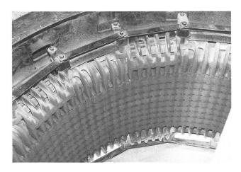
Figure 10. Stator avant nettoyage.
