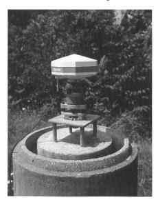
Bild 3. Zentriersystem für hochpräzise GPS-Messungen.
