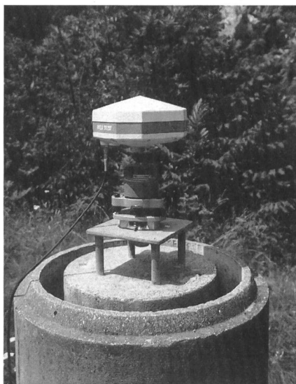
Bild 3. Zentriersystem für hochpräzise GPS-Messungen.
