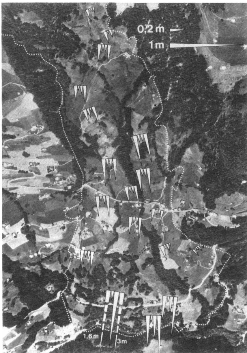
Bild 5.1. Analyse von Geländerutschungen aus Luftaufnahmen des Bundesamts für Landestopographie von 1957, 1969, 1974, 1980 und 1982. Die Pfeile zeigen die mittleren jährlichen Verschiebungen (aus Kölbl O., Stuby J. J. [20]).
