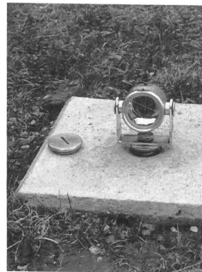
Figure 3.3. Point de contrôle: cheville centrale avec réflecteur.
