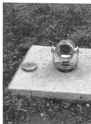
Figure 3.3. Point de contrôle: cheville centrale avec réflecteur.
