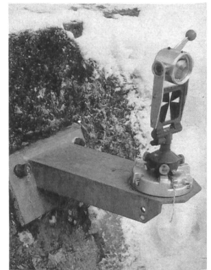
Figure 3.4. Point de contrôle: console avec cible et réflecteur.
