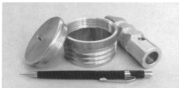
Figure 3.8. Cheville de centrage, anneau de protection et couvercle. Bild 3.8. Zentrumsbolzen, Schutzring und Deckel.
