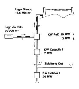
Bild 1. Ausbau der Kraftwerkstufen im oberen Puschlav.
