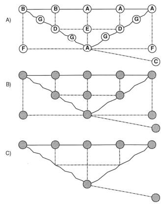
Figure 2. Instrumentation d'un barrage-voûte. A) Concept général, B) Schéma de l'équipement du barrage de Mauvoisin, C) Schéma de l'équipement du barrage de Punt dal Gall.
