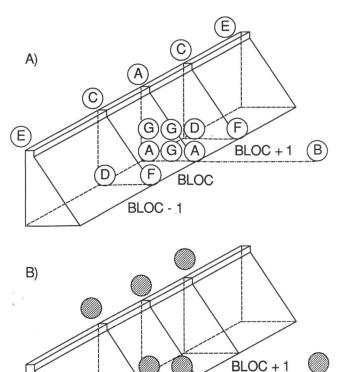
Figure 1. Instrumentation d'un barrage-poids. A) Concept général, B) Schéma de l'équipement du barrage de la Grande Dixence.
