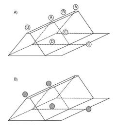
Figure 3. Instrumentation d'une digue. A) Concept général, B) Schéma de l'équipement de la digue de Mattmark.
