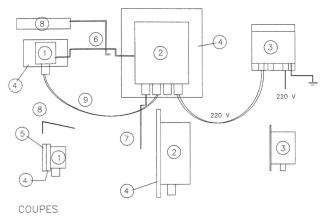
Figure 5. Schéma de montage des accélérographes. 1 Capteur, 2 Enregistreur, 3 Protection contre les surtensions, 4 Socle isolateur, 5 Socle métallique, 6 Fils de mise à la terre, 7 Câble fibre optique, 8 Toit de protection du capteur, 9 Câble du capteur.
