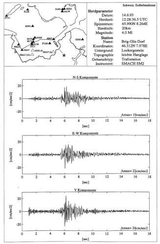
Bild 5. Beschleunigungs-Zeitverlauf des Bebens vom 14. Juni 1993, aufgezeichnet an der Freifeldstation Brig-Glis Dorf (SBRG). Die Starkbebenstation gründet auf Lockergesteinen von mindestens 100 m Mächtigkeit.
