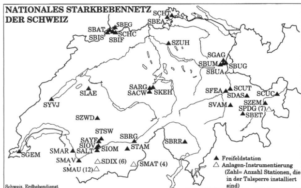
Bild 1. Nationales Starkbebennetz der Schweiz: Freifeldstationen und instrumentierte Anlagen (mit Anzahl der installierten Stationen).
