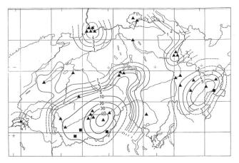
Figure 1. Carte avec courbes d'égale intensité I (MSK) pour une probabilité d'occurence de 10<sup>-2</sup> avec localisation des stations extérieures (▲) et des barrages (■).
