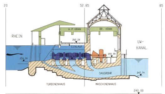
Bild 20. Schnitt 1:500 durch die neue Anlage mit Straflo-Maschinengruppen.
