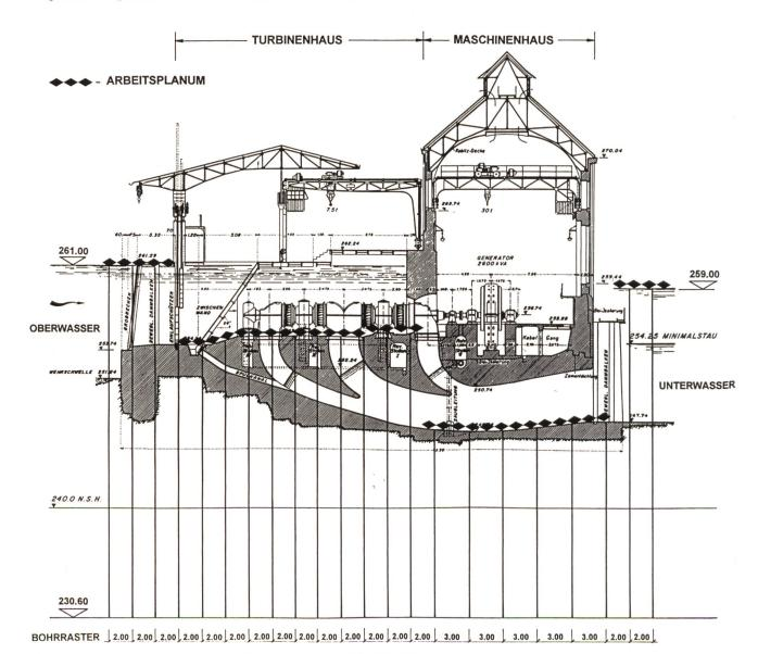
Bild 8. Injektionsbohrungen, typischer Querschnitt 1:360 mit Bohrraster und Arbeitsplanum.
