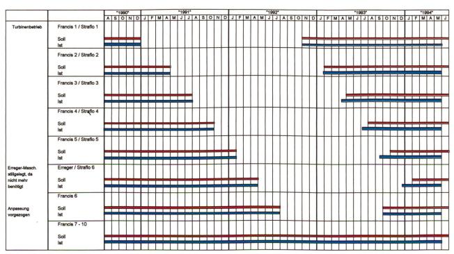
Bild 9. Ausbau Kraftwerk Wyhlen, Bauprogramm mit Soll-Ist-Vergleich.
