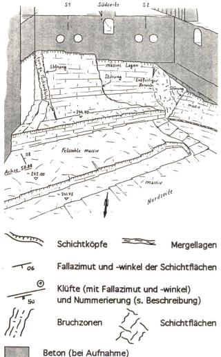
Bild 4. Geologische Detailaufnahme der Baugrube für die Straflo-Gruppe 1.
