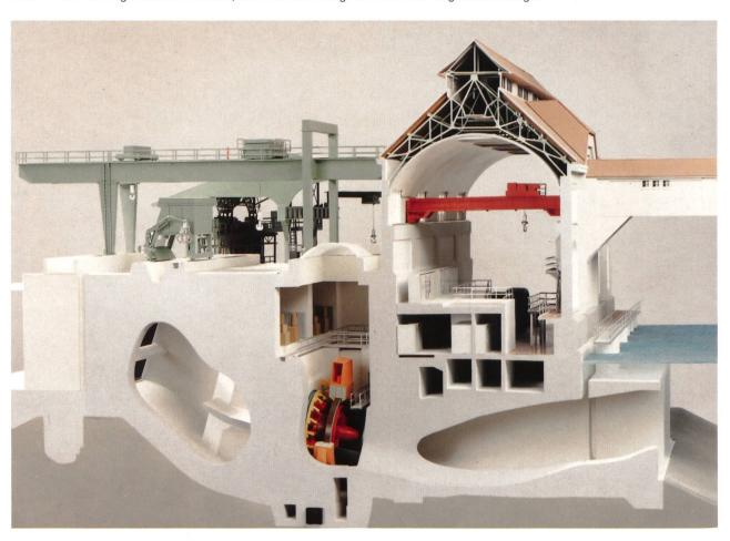
Bild 19. Schnitt 1:500 durch die bestehende Anlage mit Francis-Gruppen.
