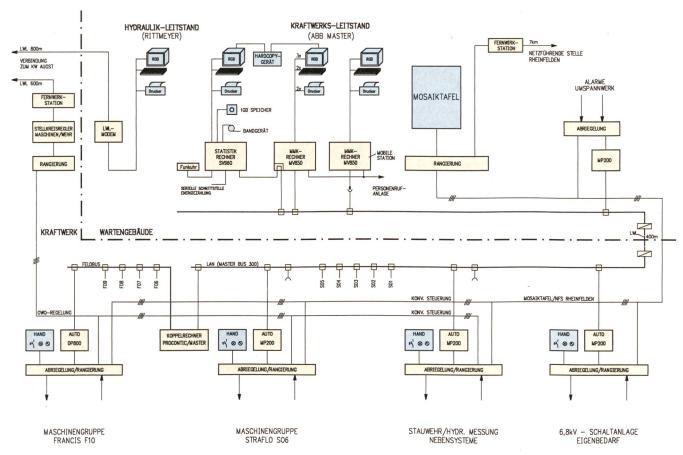
Bild 29. Prinzipschema der Leitsysteme.
