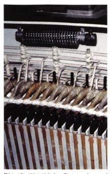
Bild 16. Wickelköpfe, Statorspulen und Stillstandsheizung.
