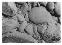
Bild 2a. Oberfläche einer innerlich kolmatierten Sohle.
