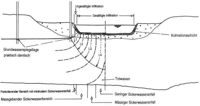
Bild 7b. Talquerschnitt mit Gewässersohle im kolmatierten Zustand.
