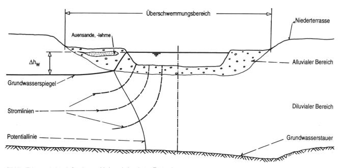
Bild 7a. Talquerschnitt mit Gewässersohle im unkolmatierten Zustand.
