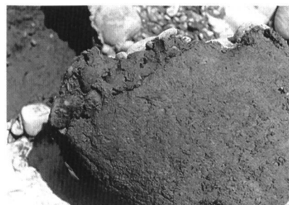
Bild 2c. An der Unterseite eines Deckschichtkorns haftende Kolmationsmasse.
