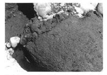
Bild 2c. An der Unterseite eines Deckschichtkorns haftende Kolmationsmasse.
