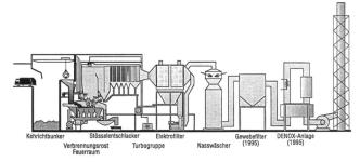
Bild 1. Längsschnitt der KVA Turgi, neue Verbrennungslinie 4.
