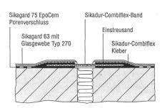
Bild 1, links. Abdichtung der Anschlussfuge zwischen Ringfundament und Stehtank mit dem Sikadur-Combiflex-System.
