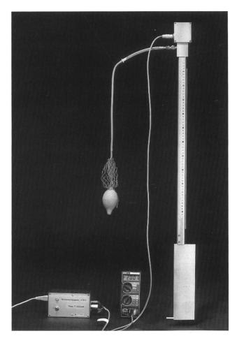
Bild 7. Gesamtdrucksonde mit Gegendruckelement; a) Messsonde, b) Gerätekopf.
