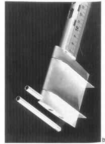
Bild 5. Gesamtdrucksonde a) Ansicht, b) Messsonde mit langer Messspitze.
