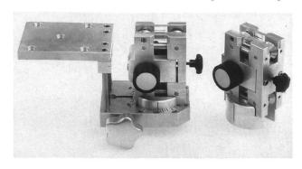
Bild 1. Messgeräteführung in Messgerätehalterung eingesetzt (links) und Schrägansicht (rechts).
