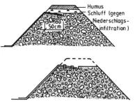
ca. 50cm Boden schräg abheben. Matten verlegen und vernageln (3-5Nägel/m²).
