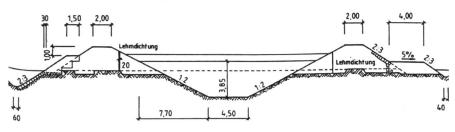
Bild 2. Kanal mit Lehmdichtung (Querschnitt).
