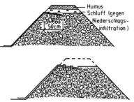
ca. 50cm Boden schräg abheben. Matten verlegen und vernageln ( 3-5 Nägel/m²).
