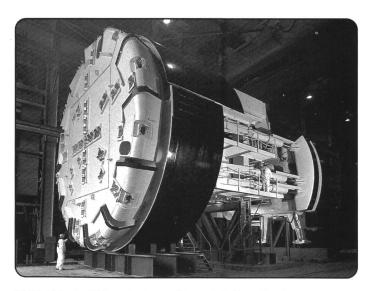
Bild 1. Vollschnitt-Tunnelbohrmaschine mit 10,80 m Durchmesser und Spitzenleistungen von täglich 36 m und mehr (TARP-Chicago, 1990. Robbins Mod. 354-254).
