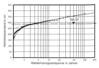
Bild 3. Bodensee-Untersee. Durchschnittliche Wiederholungszeitspanne der jährlichen Höchststände von Bild 2 (Diagramm der Landeshydrologie und -geologie, Bern).
