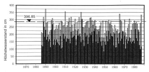
Bild 2. Bodensee-Untersee. Jährliche Höchststände (in Berlingen gemessen; Nullpunkt 394,00, schwarz bedeutet ein Winter-, weiss ein Sommermaximum) von 1886 bis 1987 im Vergleich zur Schadensmarke von 396,85 m ü.M. (Diagramm der Landeshydrologie und -geologie, Bern).
