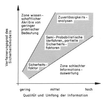
Bild 1. Bezug zwischen Verfeinerungsgrad von Sicherheitsmodellen und dem Niveau an vorhandener Information. Ein 15 m hoher Damm, gebaut in den dreissiger Jahren, ohne Bauinformation und Instrumentierung erfordert eine andere Sicherheitsbeurteilung als eine gut dokumentierte und instrumentierte hohe Bogenmauer.
