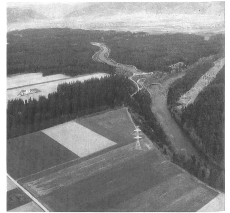
Bild 2. Die Mur heute (links) und nach dem Bau des Krafthauses für das Kraftwerk Fischen (rechts) mit Triebwassergerinne – gut in die Landschaft eingefügt (Fotomontage).
