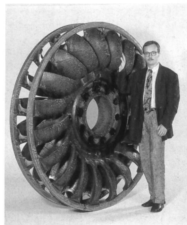
Bild 2. Altes Peltonrad mit Aussenkranz der Anlage Küblis.
