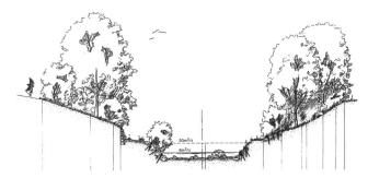
Bild 2. Querprofil im Unterwasser des projektierten Kleinkraftwerkes Füllinsdorf an der Ergolz mit Uferrenaturierung.
