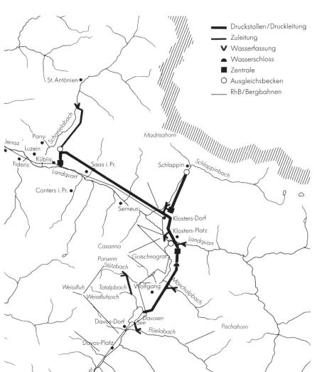
Bild 1. Kraftwerk Küblis mit Druckleitung und Unterwasser sowie Schema der Produktionsanlagen im Prättigau.
