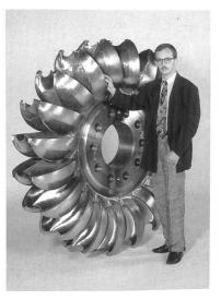
Bild 3. Neues Peltonrad der Anlage Küblis.
