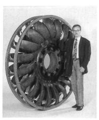
Bild 2. Altes Peltonrad mit Aussenkranz der Anlage Küblis.
