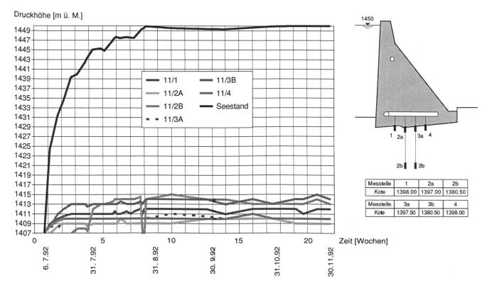
Bild 2, links. Auftriebsdrücke unter Block 11 der Staumauer Panix während des Erstaufstaus.
