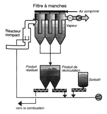
Figure 2. «Filsorption» – principe pour la séparation des dioxines.
