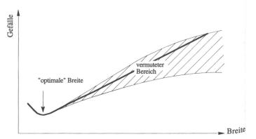
Bild 4. Einfluss der Breite auf das Gleichgewichtsgefälle bei konstanter Geschiebetransportkapazität.
