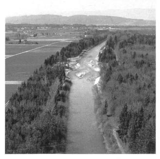
Bild 8. Emme bei Utzenstorf, links vor und rechts nach der Erstellung der 1. Etappe der lokalen Gerinneaufweitung; © Documenta Natura, Aufnahmen *H. Kobi*, Bild links am 18. September 1991 und Bild rechts am 21. April 1992.
