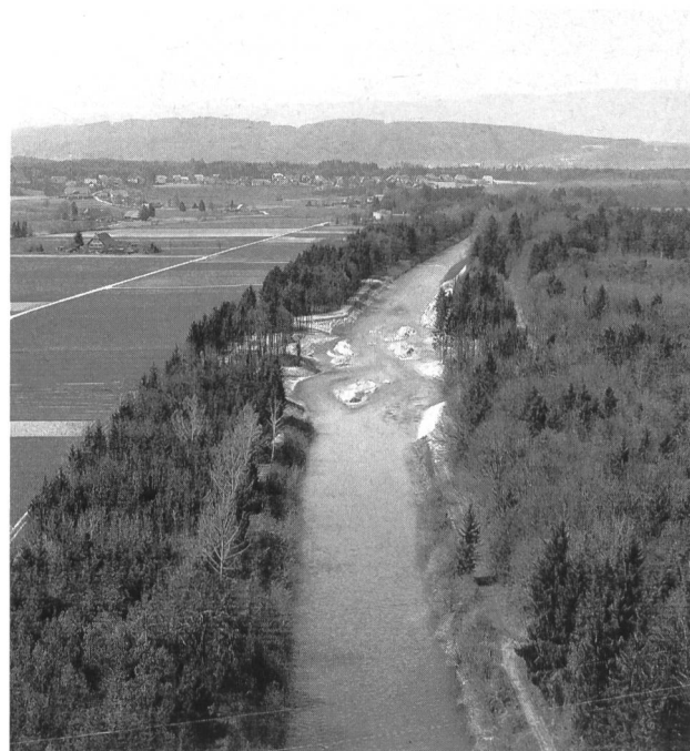
Bild 8. Emme bei Utzenstorf, links vor und rechts nach der Erstellung der 1. Etappe der lokalen Gerinneaufweitung; © Documenta Natura, Aufnahmen H. Kobi, Bild links am 18. September 1991 und Bild rechts am 21. April 1992.
