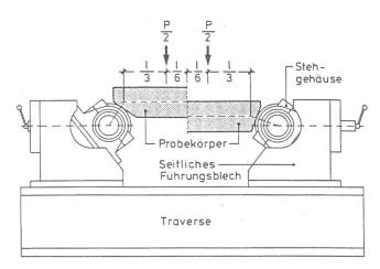
Bild 1. Die M-N-Prüfung zur Qualitätssicherung von Stahlfaserbeton für Tunnelschalen (*M* Biege*m*oment, *N* Druck*n*ormalkraft), Versuchsanordnung.
