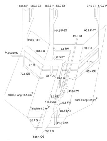
Bild 5. Schematische Wasserbilanz der Periode 1984 bis 1988. Alle Grössen in I/s. Die Abkürzungen sowie Werte in mm sind in Tabelle 1 aufgelistet.
