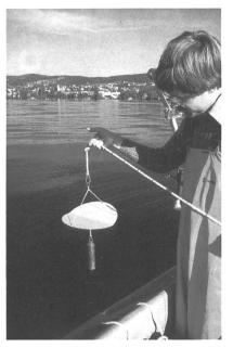
Bild 1. Die Secchi-Scheibe wird immer tiefer ins Wasser gelassen, bis sie nicht mehr sichtbar ist. Diese Tiefe und die Tiefe des Sichtbarwerdens beim Wiederauftauchen der Scheibe werden gemittelt, was ein Mass für die Lichtdurchlässigkeit des Wassers gibt.
