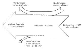
Bild 2. Wasserbilanz für den Obersee 1961 bis 1991. Die Wasserableitung durch den BWV ist sowohl als Durchschnitt der gleichen Periode wie als Wert für 1991 angegeben (letzterer in Klammern).
