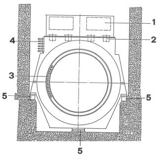
Bild 8. Dispositionszeichnung eines Straflo-Generators mit Drei-Punkt-Aufstellung.
