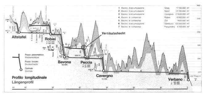
Bild 2. Längenprofil Altstafel – Verbano. 1, 2, 3 und 6 Speicherbecken; 4, 5 und 7 Ausgleichsbecken.
