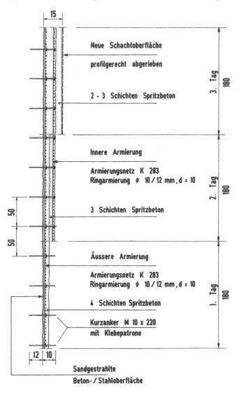
$Bild\ 8.\ Taktverfahren\ f\"{u}r\ neue\ Spritzbetonauskleidung.$
