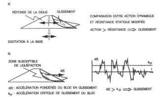
Figure 3. Calcul de stabilité au glissement d'une digue. a) Principe, b) implémentation.
