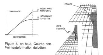
Figure 7, à droite. Discrétisation spatiale inadéquate d'un barrage-poids après fissuration (d'après *B. El-Aidi*, «Nonlinear earthquake response of concrete gravity dam systems», California Institute of Technology, Pasadena 1988, Report No. EERL 88-02).
