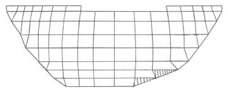
Figure 11. Discrétisation spatiale inadéquate d'un barrage-voûte (éléments hachurés).
