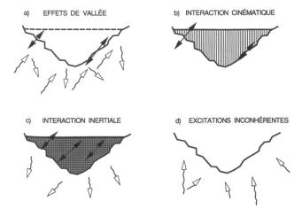
Figure 14. Interaction sol-structure pour barrages-voûtes. a) Effets de vallée, b) interaction cinématique, c) interaction inertiale, d) excitations incohérentes.
