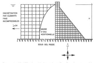
Figure 5. Modélisation bi-dimensionnelle d'un barrage-poids (schématique).
