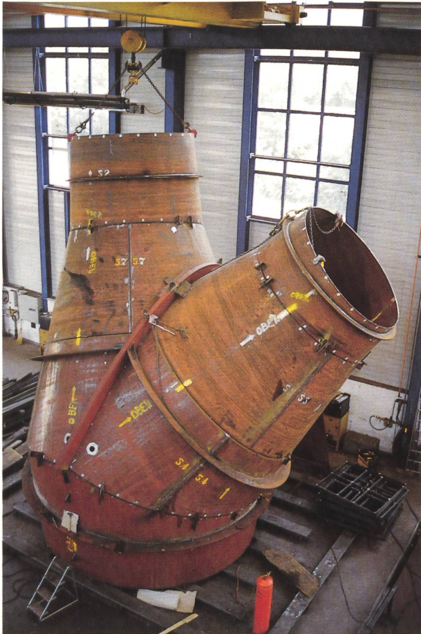
Bild 5.4. Die Endzone des Druckstollens, der Druckschacht sowie die beiden Verteilungen sind mit Stahl gepanzert. Die teilweise vormontierten Teile des Hosenrohrs wurden vor Ort zusammengeschweisst. Die beiden Verteilungen und das Hosenrohr werden einer Druckprobe unterzogen.
