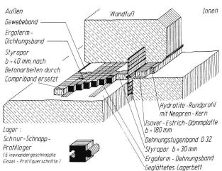
Bild 2. Aufbau der Lager- und Dichtungskonstruktion der Ringfuge des Wasserbehälters.
