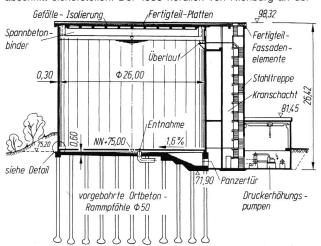
Bild 1. Wasserbehälter mit 10 000 m3 Inhalt (Schnitt).
