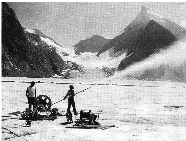
Bild 2. Testlauf vor Beginn einer Bohrung im «Konkordiaplatz» (Grosser Aletschgletscher): Überprüfung der Düse an der Bohrstange. Links im Bild die Schlauchwinde.
