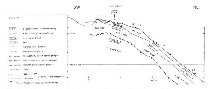
Bild 2. Geophysikalische Eigenschaften des Moränendamms am Sidelengletscher (Gerental/Obergoms). Die Sondierungen wurden 1988 im Rahmen der «Ursachenanalysen Hochwasser 1987» durchgeführt.
