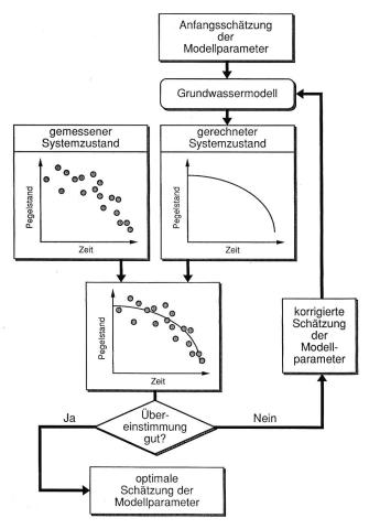
Bild 1. Prinzipschema der inversen Modellierung.
