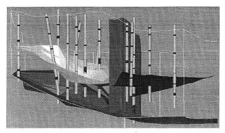
Bild 2. Chalk River Block: Situation, Klüfte und Bohrungen mit Packern.
