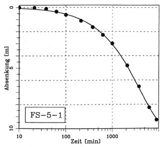
Bild 3. Vergleich zwischen Rechnung und Messung in einem Testintervall der Bodenkluft K1.
