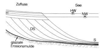
Bild 2. Schnitt durch ein Delta: diskordante Schichten: Deltaschüttung (DS) und horizontale Übergussschüttungen (H), in weiterer Entfernung Schwebstoffablagerungen (S).
