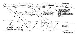
Bild 1. Profil eines Abtragungsufers (oben), Brandungs- und Rippströmungen mit Sedimenttransport infolge der Windwellen (unten).
