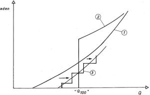
Bild 2. Schadensfunktionen für ein «natürliches» Gerinne (Kurve 1), ein Verbauungssystem, das bei Überschreiten der gewählten Ausbaugrösse kollabiert (Kurve 2), und ein Verbauungssystem mit differenziertem Schutzzielkonzept (Kurve 3).
