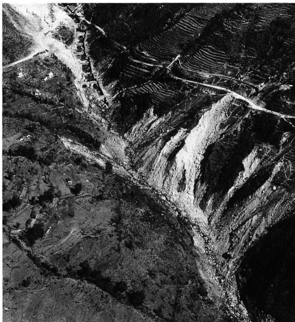
Bild 1. Situation am Charnawati im Frühling 1990. Unterhalb der Strassenquerung (am linken oberen Bildrand) ist der Fluss mit Steinkorb Sperren verbaut. Im anschliessenden Steilbereich erreichen die ausgedehnten Hangrutsche die Strasse.
