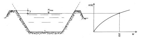
Bild 1. Ausbauwassermenge  $Q_{\rm max}$  im Vergleich zu einer Extremwertverteilung der Wasserstände, wobei angenommen ist, dass diese aus einer Extremwertverteilung der Abflüsse umgerechnet und für fiktiv erhöhte Ufer dargestellt sind.
