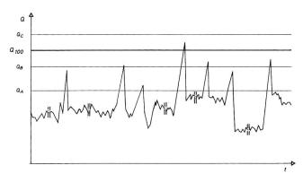
Bild 3. Hypothetischer zukünftiger Ablauf der Hochwässer während einer angenommenen hundertjährigen Lebensdauer eines heute erstellten Schutzwerks. Vergleich mit einer konventionellen Dimensionierungswassermenge  $Q_{100}$  und einer Gruppe von drei Grenzwerten  $Q_{\rm A}$ ,  $Q_{\rm B}$  und  $Q_{\rm C}$ , welche einem Ansteigen der Schadensfunktion gemäss Kurve 3 von Bild 2 entsprechen.
