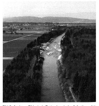
Bild 2. Analoges Bild wie 1, Zustand nach der Aufweitung des Profils (Documenta Natura).
